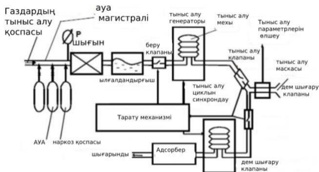
2.4 сурет – ӨЖЖ аппараттарының жалпы құрылымдық схемасы
